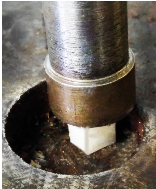
Рис. 2.7. Зразок цементу під час випробувань
